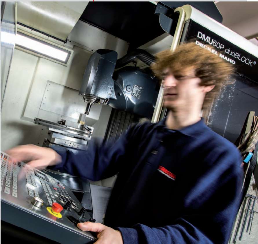
DECKEL-MAHO DMU 60P eVolution 5-axis machining centre, motor spindle 18.000 rpm, 600x700x600 mm range, tool magazine 60 stations, tool presetter tracer point and laser. 5-Achsen Bearbeitungszentrum, 18.000 umd/min, Arbeitsbereich 600x700x600 mm, 60 Werkzeuge, Messtaster und Laser-Werkzeugmesssystem.
